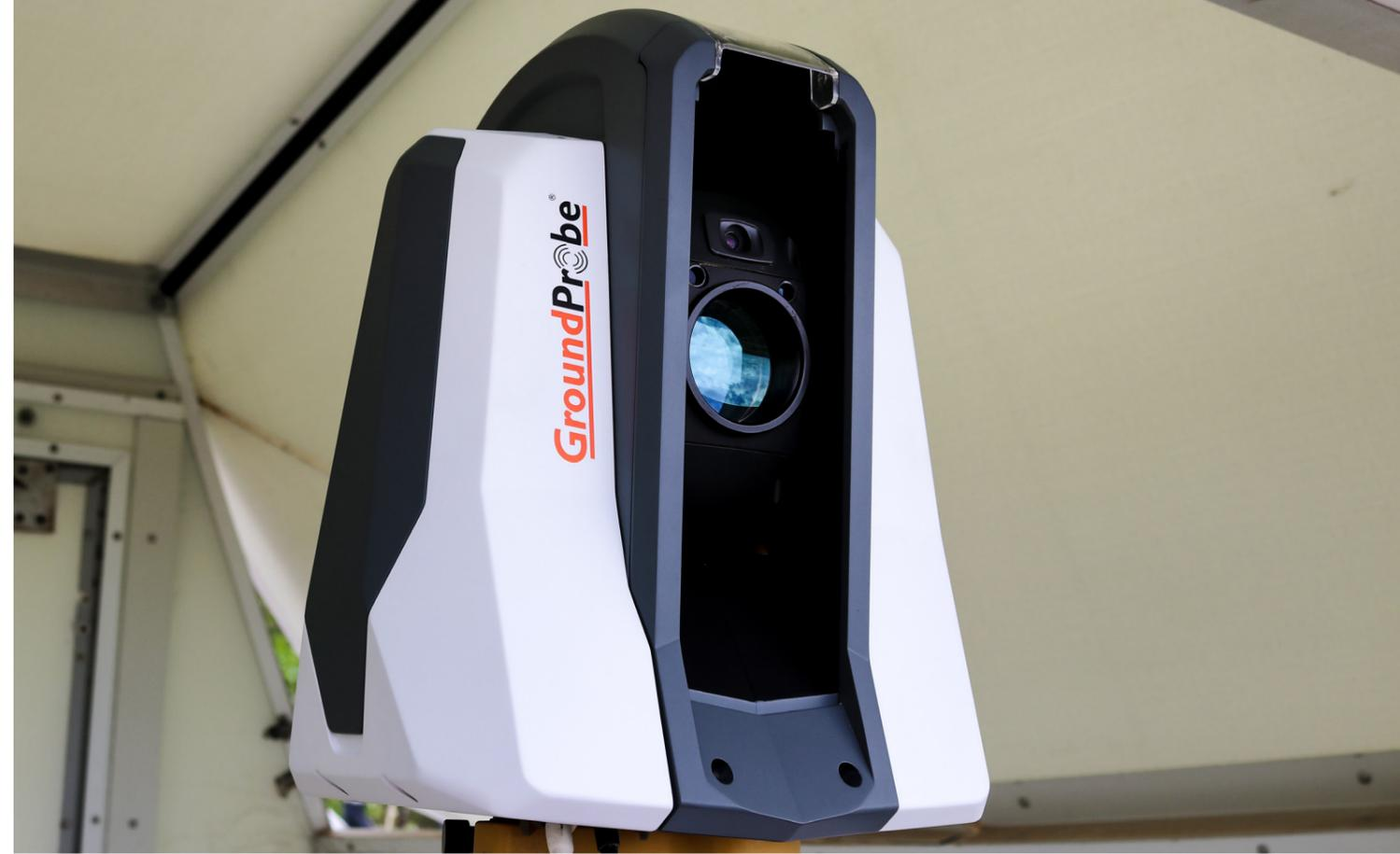
Se pueden escanear varias áreas a intervalos regulares con un solo dispositivo, lo que permite la cobertura periódica de varias áreas activas.
