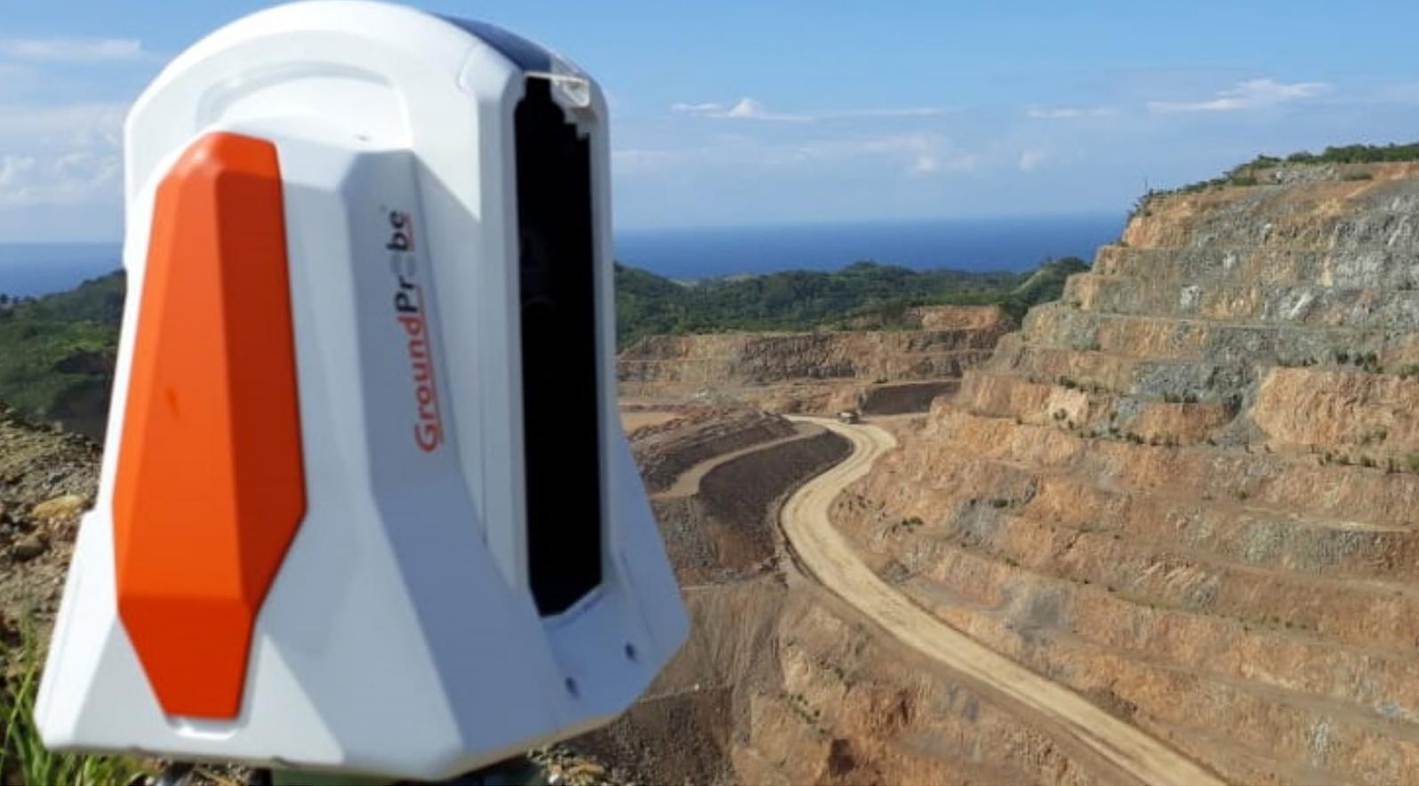
Система GMS-Dual осуществляла непрерывный мониторинг, успешно выявив сдвигение породы на субмиллиметровом уровне, что демонстрирует её высочайшую точность и безошибочность.
