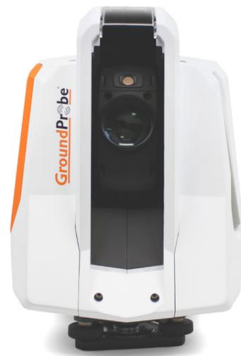
измерения деформаций, другой для визирования призм. Такая схема позволяет гарантировать, что местоположение призмы не будет утрачено, даже если она сдвинется. При этом для получения информации о координатах не нужно будет полагаться на архивные данные. Система GMS отслеживает, находит и фиксирует фактическое положение призмной точки во время каждого сканирования.
