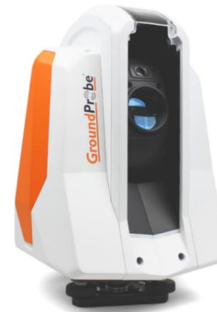
Na frente da inovação, o GMS é o primeiro da indústria. Ele não apenas monitora os prismas, mas também é capaz de monitorar pontos “virtuais” na parede que refletem o sinal do laser diretamente da rocha. O sistema também é totalmente compatível com o nosso software de análise, o SSR-Viewer. Suas poderosas ferramentas de visualização de dados, gráficos e análise levam o GMS bem além das capacidades das Estações Totais Robóticas típicas.
